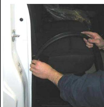
Scostare leggermente la plastica del montante interno, in modo da poter fare entrare il cablaggio e collegarlo al connettore
