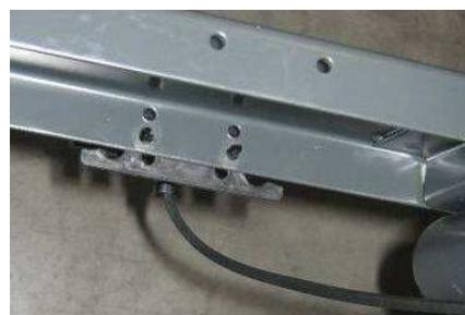
2. fissare la luce arancio al supporto utilizzando le viti in dotazione autofilettanti M4,2x25 mm (cod. 103001)
