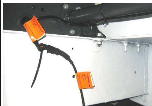
Per entrare con il cablaggio in cabina togliere il tappo situato nella parte inferiore della cabina lato destro
