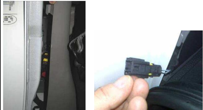
Dopo aver collegato i connettori riporre i cablaggi all'interno del montante e riposizionare la guarnizione alla porta della cabina
